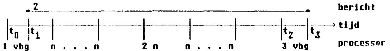
Figuur B4. Maximale berichtlengte voor gebied II. 1, 2 en 3 zijn de zenders, n zijn de processoren die "over" zijn.
