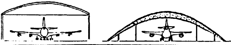
fig. 3.18 Hangars met gebogen constructie
