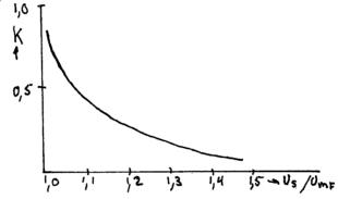
Whitehead en Dent ( Proc. of the Int. Symp. on Fluidisation, Eindhoven 1967 pag 802 e.v.) hebben metingen verricht aan verdelingssystemen waarin luchtaan het bed wordt toegevoerd d.m.v. tuyeres (verdeelpijpen). Deze tuyeres hebben een kwadratische karakteristiek:  $\Delta P_p = c \cdot u_s^2$
