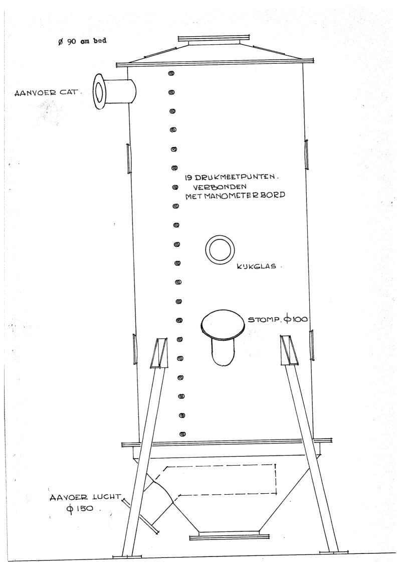
3) het Ø 90 cm bed bestond uit resp. conus(staal), cylindrische romp(staal), deksel(staal), en verdeelplaat. Hieraan gekoppeld was de secundaire apparatuur. Zie tekening pag 11a.
