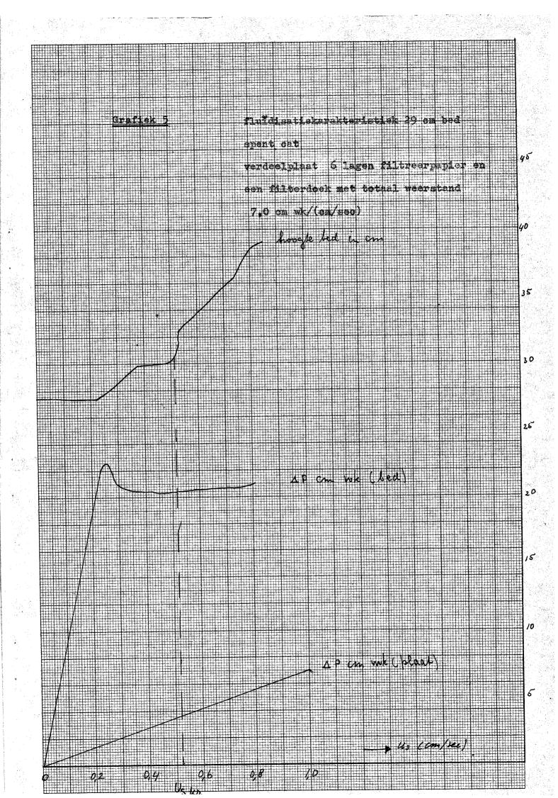
De kritische drukverhouding is niet constant en niet als criterium te gebruiken. Whitehead en Dent vonden resultaten waaruit afgeleid kan worden dat bij grote gassnelheden en bedhoogten de kritische drukval over de verdeelplaat onafhankelijk is van de bedhoogte en afhankelijk van de beddiameter. Dat er een afhankelijkheid is van de beddiameter is, wordt plausibel gemaakt in Appendix III. Als nieuw kengetal wordt nu geïntroduceerd:
