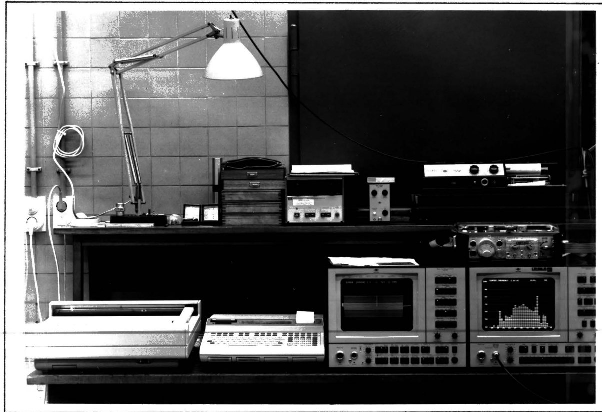
Meetapparatuur opgesteld bij de meetkamer met v.l.n.r. plotter (HP 9872A), calculator (HP 9825A), smalle band spectrum analysator (B&K 2031), digitale frequentie analysator (B&K 2131)
