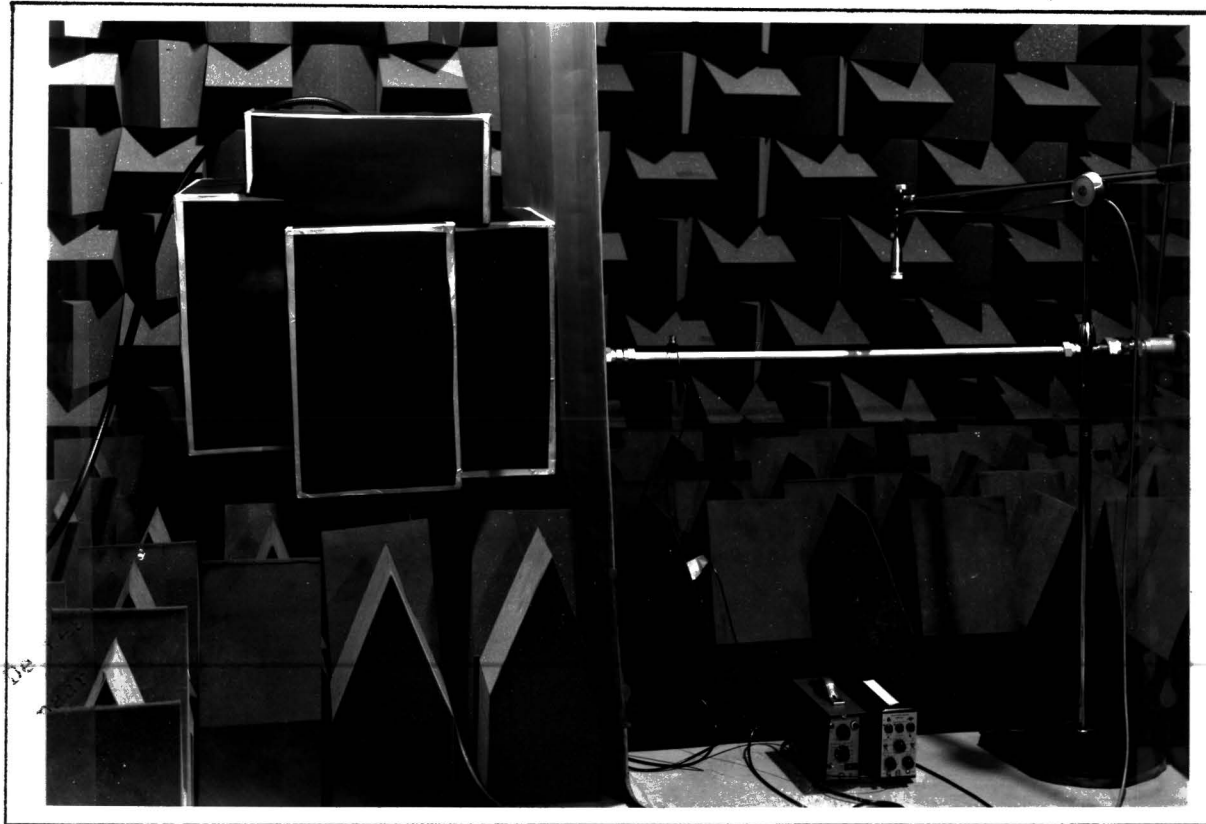
Meetopstelling in de meetkamer met v.l.n.r. statief met triltafel (afgeschermd), "gordijn", meetpijp, lagedrukslang
