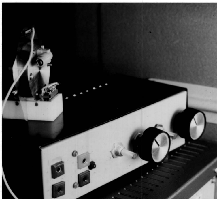
Foto 1. De zelfgebouwde drukopnemer met de meetbrug. Het witte draadje vormt de aansluiting voor de condensatorspanning op het membraan.
