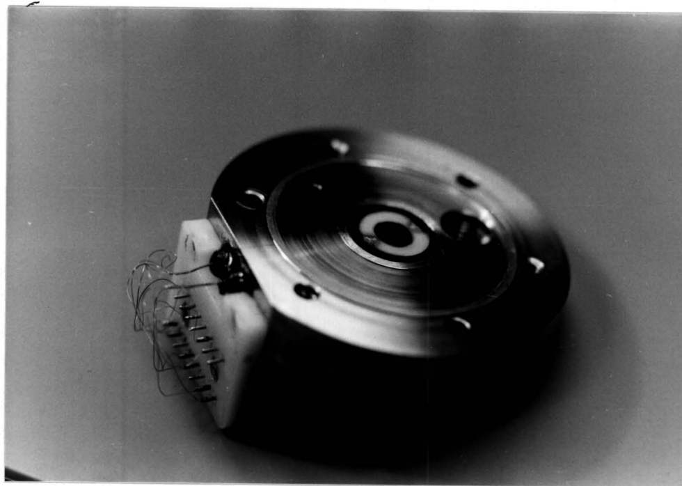
Foto's 2 en 3 : De eigen drukopnemer, onderdelen en losse spoeltjes. De aansluitingen van de spoeltjes.
