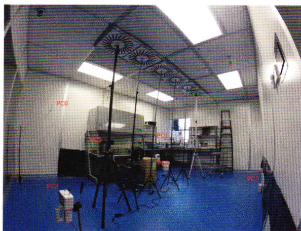
Figuur 1 (boven): Foto van de mock-up van de laboratorium cleanroom situatie waarin de metingen zijn uitgevoerd [links] en een plattegrond van de ruimte [rechts] waarin de locatie van de deeltjestellers, (PC), ventilatie/filter units (FFUs; 1-9), afvoerroosters (A-E) en bronpositie (S) zijn aangegeven. 'h' is de hoogte van de meetpositie ten opzichte van de vloer.
