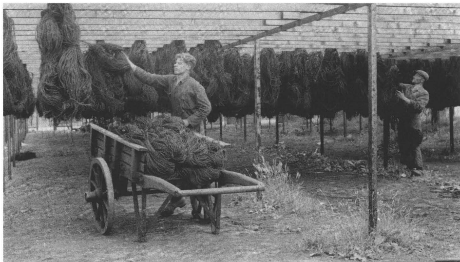
Afb. 5. Het drogen van de geschoonde en geverfde garens gebeurde aanvankelijk voornamelijk door natuurlijke droging, onder een afdak in de open lucht. Deze werkwijze vond nog tot in de jaren vijftig toepassing. Maar met name in de wintermaanden was kunstmatige droging nodig die hoogstwaarschijnlijk vanaf het begin heeft bestaan.
