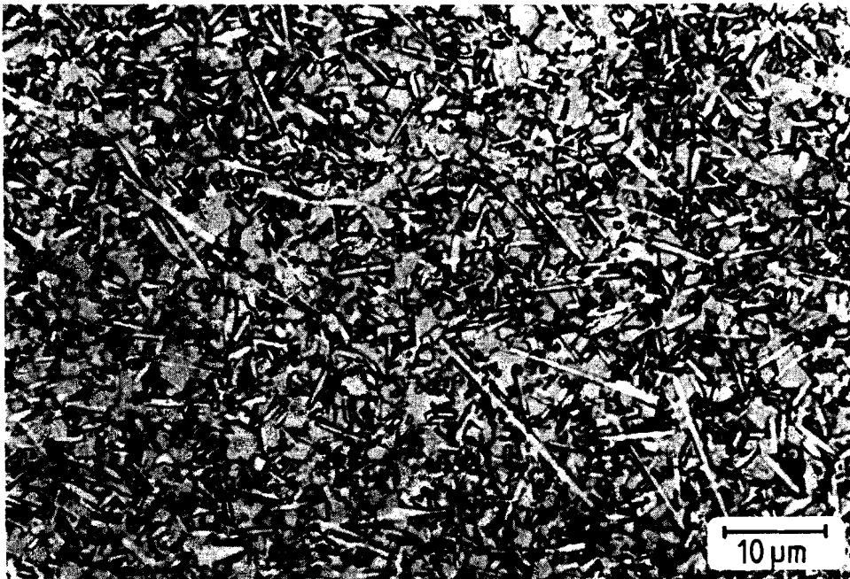
Bild 94: Gefügaufnahme einer mit SiC-Whiskern (20 % Massegehalt) verstärkten \text{Al}_2\text{O}_3 -Basis-Keramik [20]
