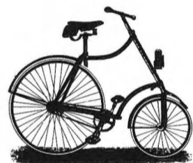
De 'Humber Dwarf Safety' uit 1885 is afgeleid van de 'Cripper' driewieler
