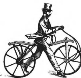
Het 'loopwiel' van baron von Drais uit 1818, met wielen van ± Ø 0.70m
