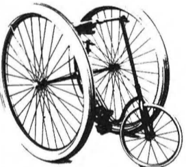
De driewieler die Dunlop in 1887 voorzag van luchtbanden
