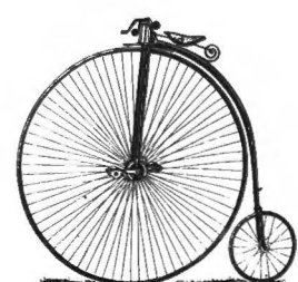
De voorwielen van de sportmachine zijn in 1872 al Ø 1.55m (deze is uit 1889)
