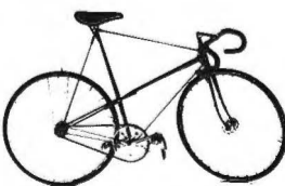
De spanfiets van de la Haye (1881), kruisframe gecombineerd met drieboeken, zoals bij de 'Psycho'
