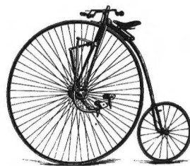
Singer's 'Xtraordinary' uit 1879 heeft een hefboom-aangedreven voorwiel van \pm \varnothing 1m
