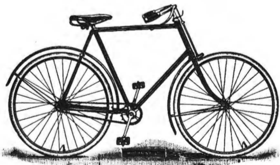
Een 'Humber' uit 1896 met wielen van \varnothing 0,71m
