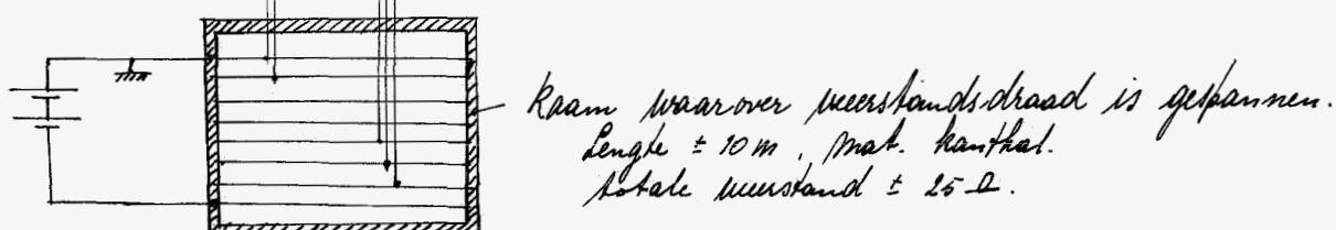
De uiteinden van deze weerstandsdraden worden verbonden met de klemmen van twee in serie gekoppelde 12 volts accu's.
