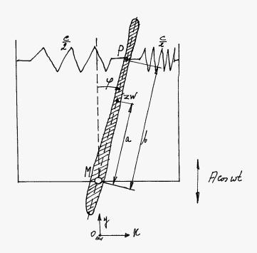
Van het hierboren geschetste systeem wordt de bewegingsvergelijking bepaald. De gearceerde talk kan roteren om het punt M. Twee massabre veren (veesconstante van een veer is  $\frac{e}{2}$ ) sijn op een afstand
