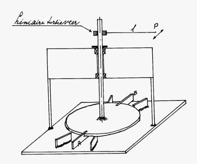
Het beskouwde tysteem bestaat nit een verticaal draaibare as, die loodrecht staat op een horisontale schift, waaraan tuee magneten (A en B) bevestigd sijn.
