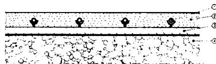
fig 23 e buizen op zadels in het hart van de dekvloer
