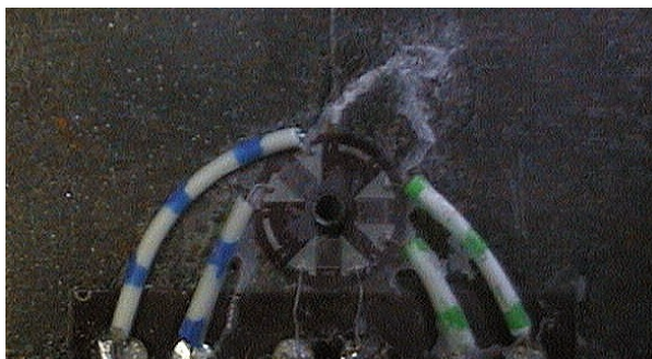
foto 3: rekrozet na boren gat
