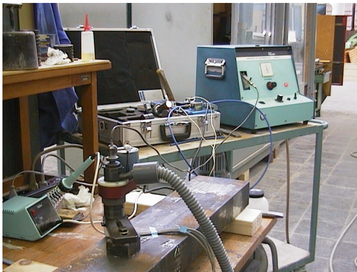
foto 2: totaal beeld Air abrassive system
