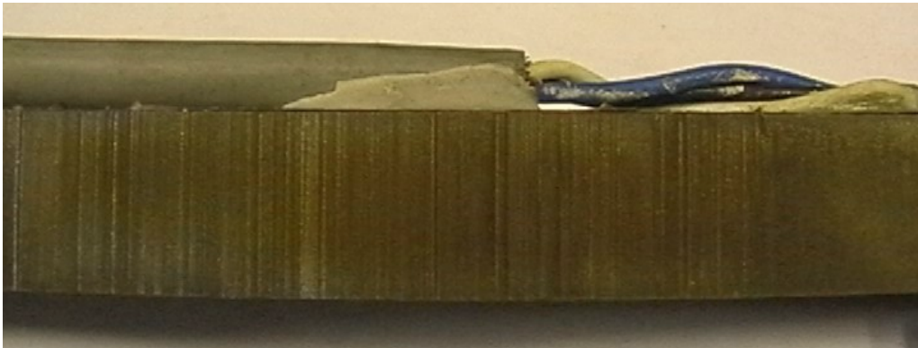
foto 12: geribbeld oppervlak door raken van de rekstrook tijdens het vonken
