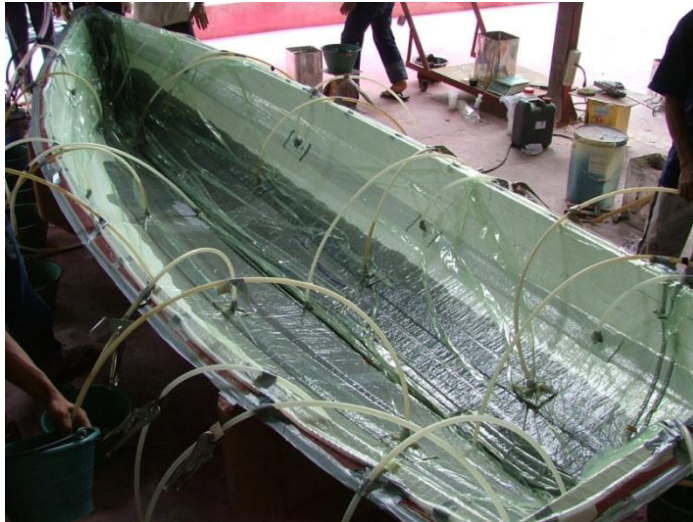
Afbeelding 4. Het vacuüminfusie-proces van een bootromp. Bron: boatdesign.net
