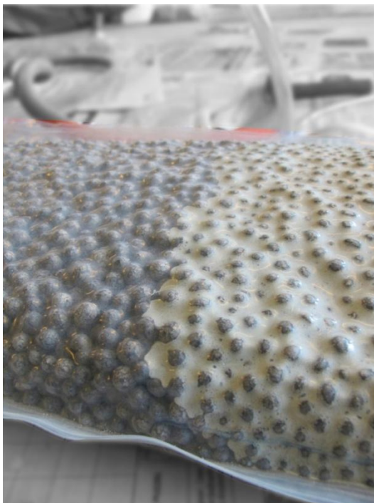
Afbeelding 7. Gedurende het vacuüminfusie-proces wordt betonmengsel door de holtes in het granulaat 'getrokken'.
