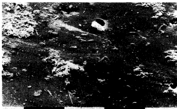
Fig. 4. SEM opname van een belast (a) en onbelast (b) strookje (X5600).
