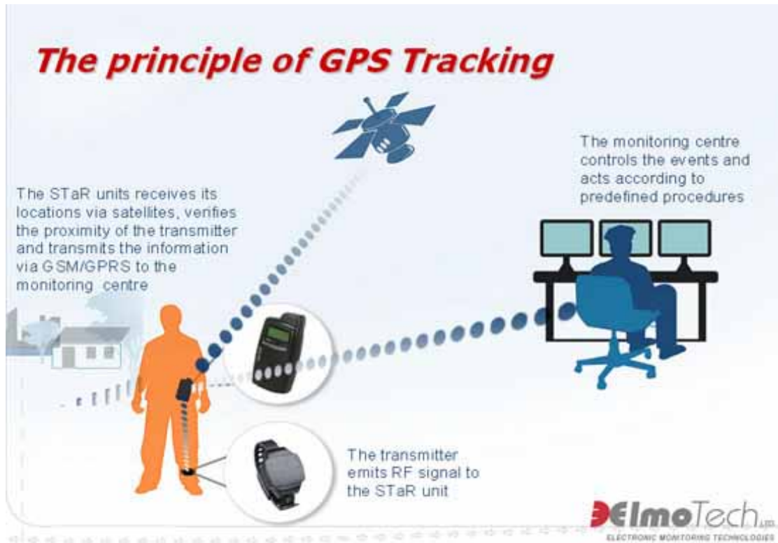
Figuur 16. De werking van GPS-plaatsbepaling schematisch weergegeven. 126
