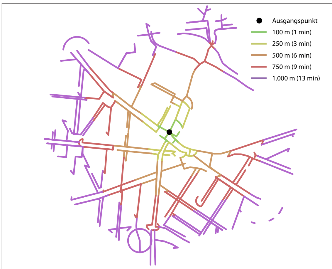
Abb. 33: Konstruktion des Pfadbaums für die Isochronenzonen (eigene Darstellung)
