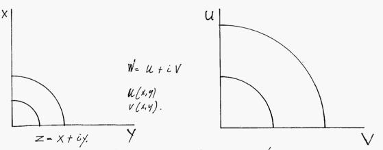
Maak van de oorspronkelyke doordnede een lonforme æfbeelding. In ons geval een hiniaire æfbeelding, mbv. de genchie  $W = u^{(x,p)}i V(x,y)$  De lauchy-Riemann Relatie Moet gelden:  $ul. \mid \frac{\partial u}{\partial x} = \frac{\partial V}{\partial y}$
