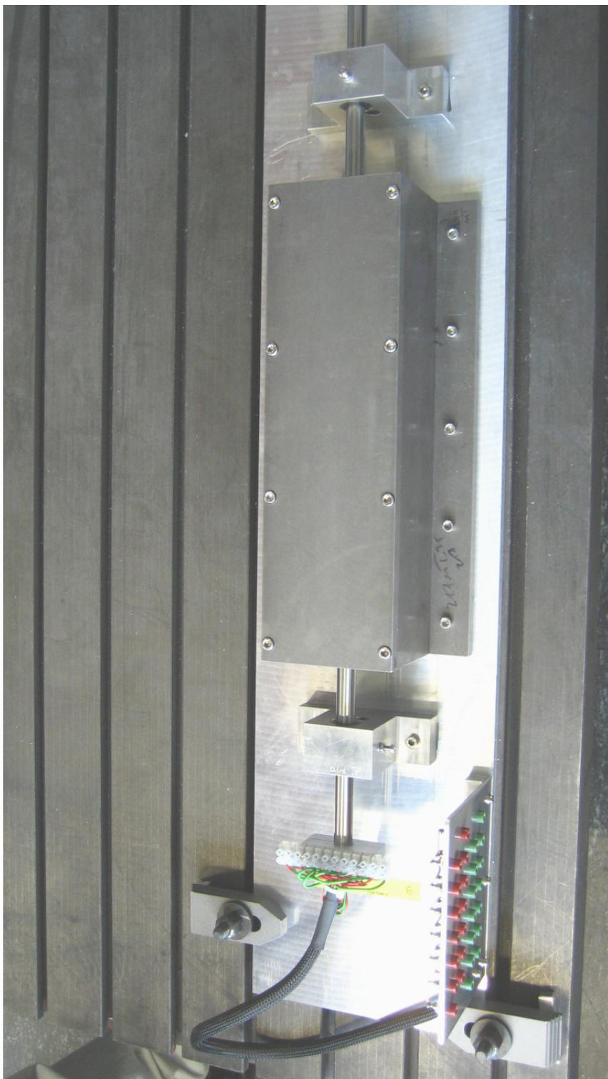
Abb. 6.4.8: Gesamtaufbau des synchronen TFM-Lineararmotors
