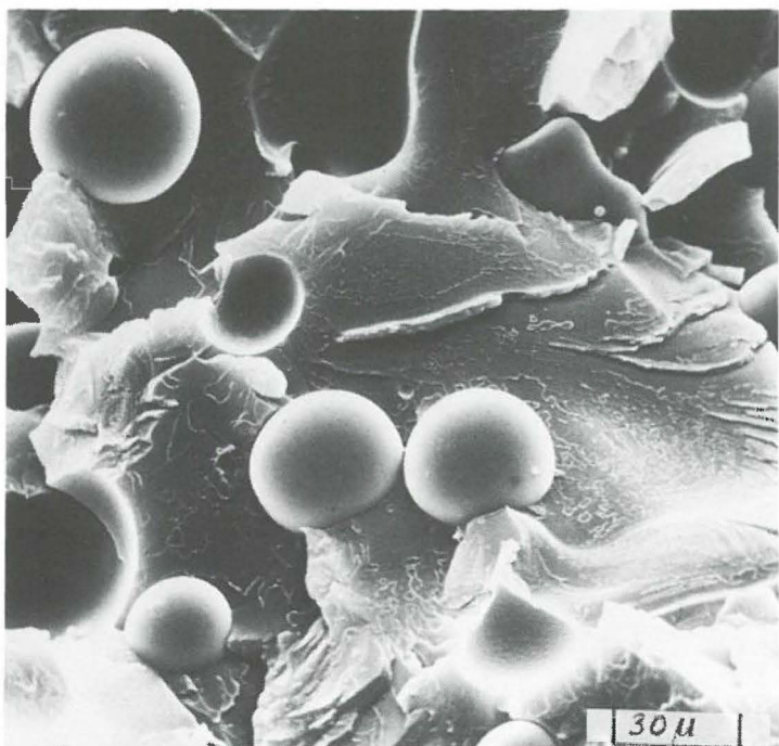
Figuur 9. Breukvlak van polystyreen en glasbol mengsel zonder hechting.
