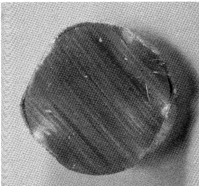
Figuur 23. Door hameren plastisch gedeformeerde coating van FeCrAlY op AISI 316.
