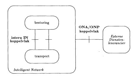
Relatie Intelligent Netwerk en 'Open Network Architecture/ Open Network Provision'
