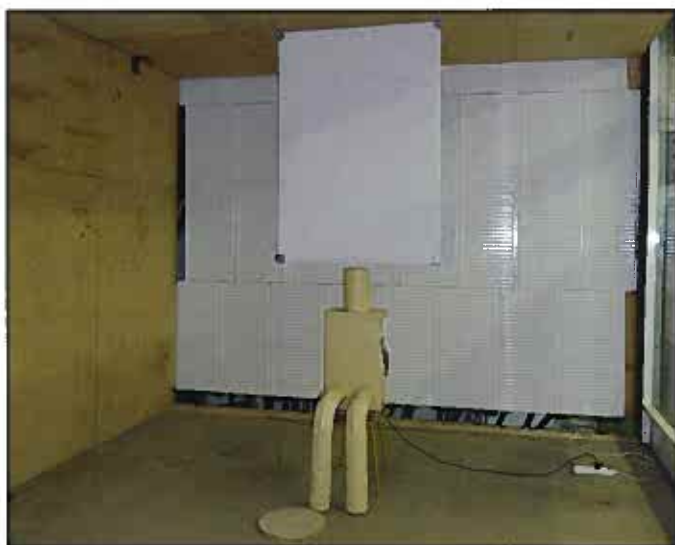
Obr. 4 Experimentální komora s termální figurínou
