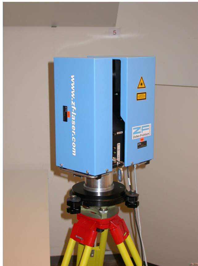
Abb. 5.13: Laserscanner ZOLLER+FRÖHLICH Imager 5003.
