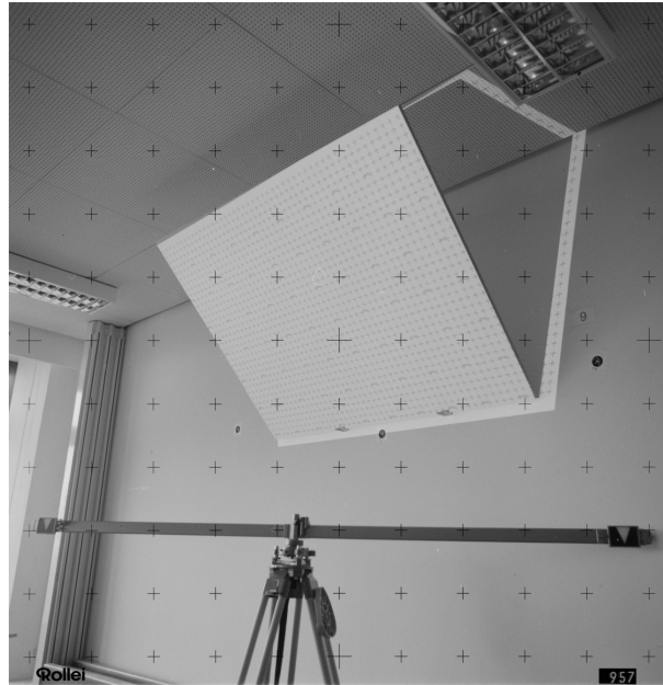
Abb. 5.9: Projizierte Targets auf der Oberfläche einer Testfeld-Kalibrierplatte (Messbild).
