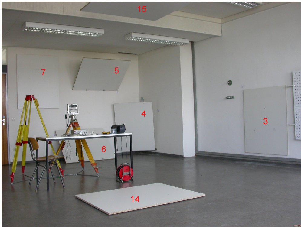
Abb. 5.8: Realisierung eines Testfeldes mit Kalibrierplatten (Ausschnitt). Zur Darstellung des Grundrisses siehe auch Abbildung 4.9.
