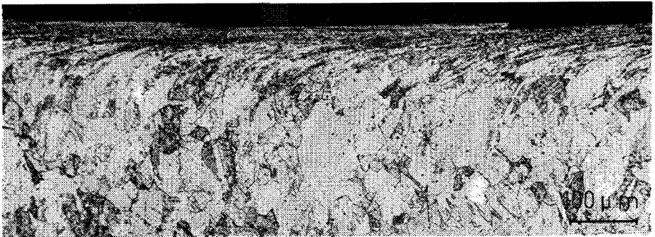
Stufen in einem Kupferquerschnitt senkrecht zur Gleitfläche und parallel zur Reibrichtung.
