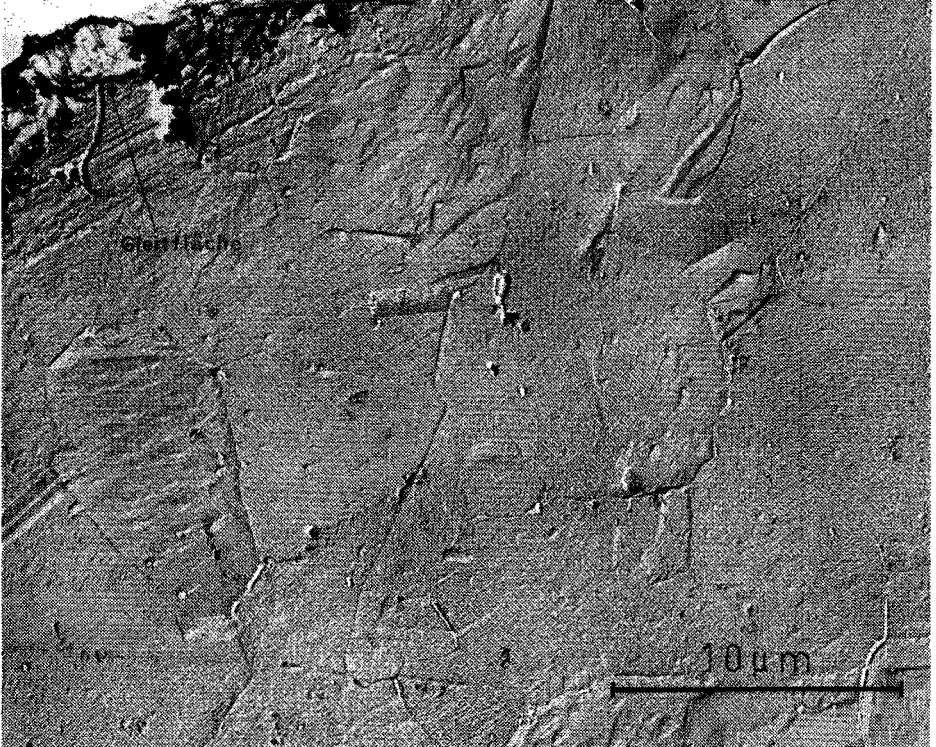
Oberflächenabdruck eines Querschnitts senkrecht zur Gleitrichtung eines bei 150 °C rekristallisierten Kupferstiftes.
