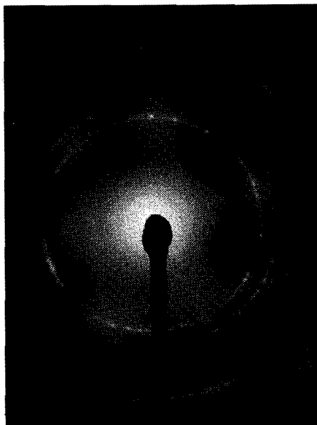
Eine Elektronenbeugungsdurchstrahlungsaufnahme von Bild 4.9 (Grösse des angestrahlten Gebietes ca. 1 \mu\text{m}^2 ).
