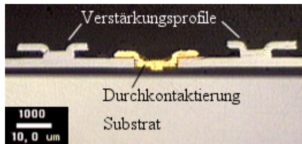
Abbildung 6.12: Foto eines Schliffs quer durch die Verstärkungsprofile des Relaisankers.
