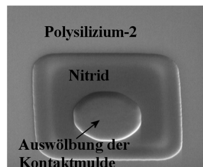
Abbildung 6.11: Im linken Bild eine REM-Aufnahme des isolierten Kontaktlochs von oben mit der tieferliegenden, kreisförmigen Kontaktmulde.
