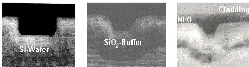
Abb. 3.48: REM-Aufnahmen ( R aster- E lektronen- M ikroskop) eines in Silizium geätzten rechtwinkligen Graben (links), des oxidierten Graben (Mitte) und des in Silizium geätzten oxidierten Graben verfüllt mit PMMA 20 % CN als Führungsschicht abgedeckt mit einem Claddinglayer (rechts).
