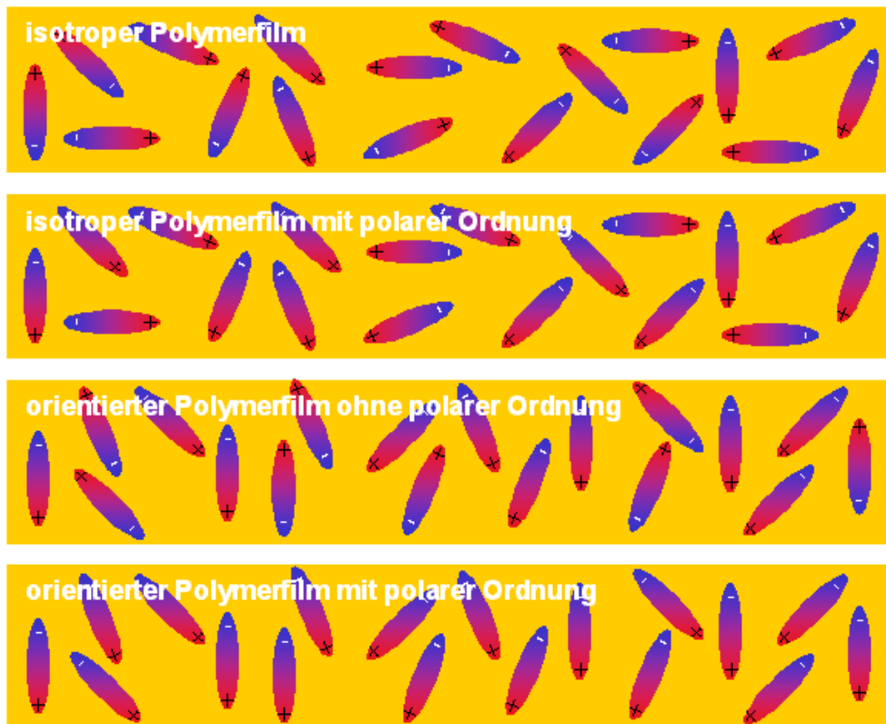
Abb. 3.25: Ungepolter isotroper Polymerfilm, die NLO-Moleküle sind ohne Vorzugsrichtung statistisch verteilt; gepolter isotroper Polymerfilm, bei dem sich eine Vorzugsrichtung bezüglich der molekularen Dipolmomente der NLO-Moleküle ausgebildet hat, die NLO-Moleküle aber weiterhin statistisch verteilt sind; orientierter Polymerfilm, bei dem die Moleküle eine Vorzugsrichtung besitzen, die molekularen Dipolmomente jedoch statistisch verteilt sind; orientierter Polymerfilm, bei dem sich neben der Vorzugsrichtung der Moleküle auch eine Vorzugsrichtung bezüglich der molekularen Dipolmomente ausgebildet hat (von oben nach unten).
