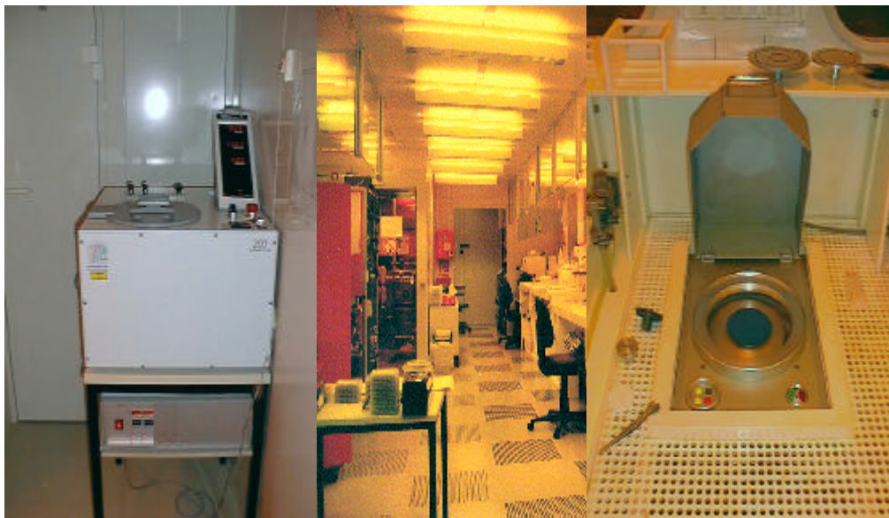
Abb. 3.8: Nach der Reinigung der Substrate in Aceton mittels Ultraschallbad werden diese zusätzlich im Plasmaverascher ( O_2 , 400 W, 15 min) (links) von organischen Verschmutzungen befreit und anschließend Polymerschichten durch spincoating (rechts) aufgebracht. Das mittlere Bild zeigt den Reinraum des Instituts für Hochfrequenztechnik der TU-Berlin, in dem die optisch nichtlinearen Polymerschichten hergestellt wurden.
