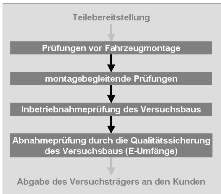
Abbildung 5.1: Überprüfung elektronischer Systeme im Versuchsbau
