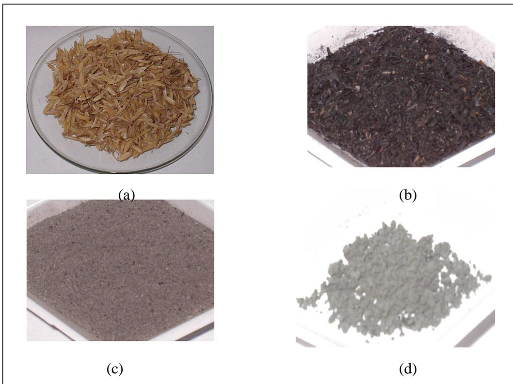
Abbildung 4.1.1.1: (a) getrocknete Reishülsen; (b) Reishülsen-Asche (400°C; 3 h; Luft); (c) Reishülsen-Asche (1000°C; 3 h; Argon-Atmosphäre); (d)  $\beta$ -SiC aus Reishülsen-Asche (1500°C; 4 h; Vakuum).
