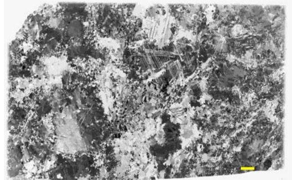
Abbildung 131: Dünnschliffe von Moria-Marmoren mit wenigen (o. LbMo3) und vielen (u. LbMo4) Fossilresten, N+, Maßstabsbalken 2 mm
