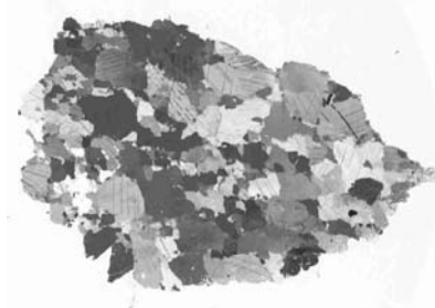
Abbildung 264: Dünnschliff Dionysos und Satyr von Faustinathermen Milet, N+, Maßstabsbalken 2 mm
