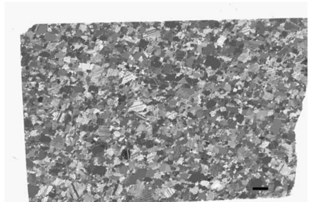
Abbildung 230: Prokonnesischer Marmor (GF110-7), N+, Maßstabsbalken 2 mm
