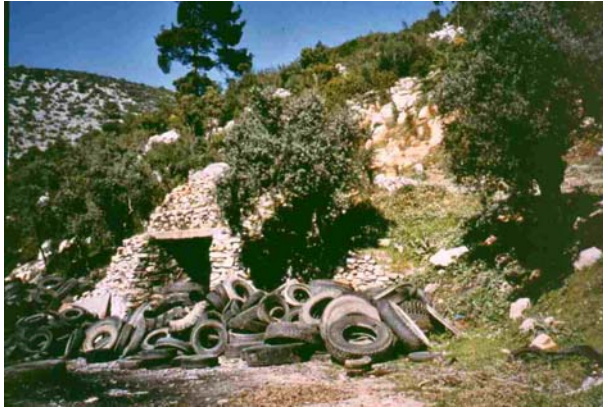
Abbildung 146: Kalkbrennofen in den Milet-West-Brüchen. Die Altreifen dienen als Brennmaterial zur Kalkgewinnung
