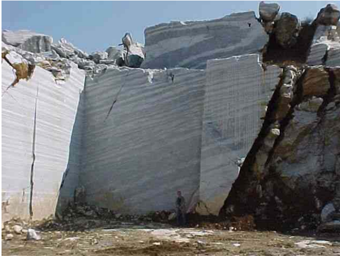
Abbildung 93: Steinbruchwand von rezentem Abbau bei Mandira, im Block oben isoklinale Faltung
