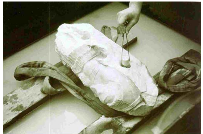
Abbildung 20: Entnahme eines Bohrkerns am Telephosfries
