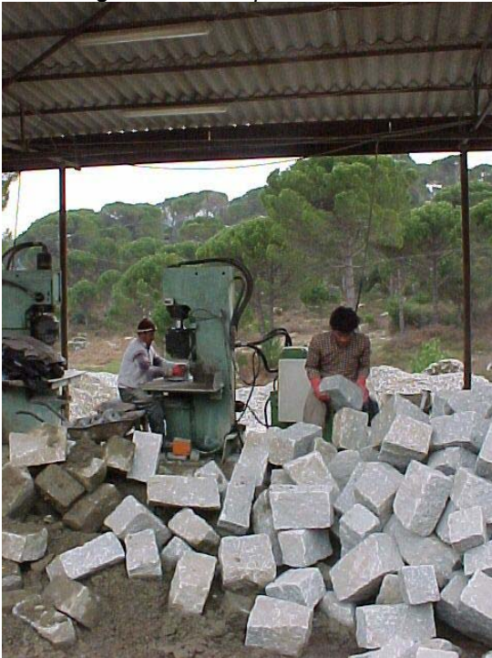
Abbildung 305: Weiterverarbeitung von Granodioriten für den Straßenbau
