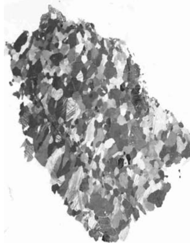
Abbildung 278: Columna Caelata mit stark gelängten Calcitkristallen, N+, Maßstabsbalken 2 mm
