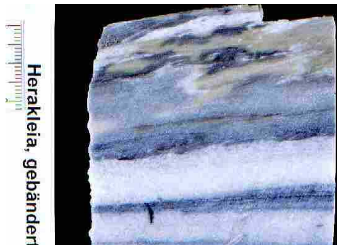
Abbildung 26: Feinkörnige dunkle, dolomitreiche Bänder in grobkörnigeren Marmoren von Herakleia
