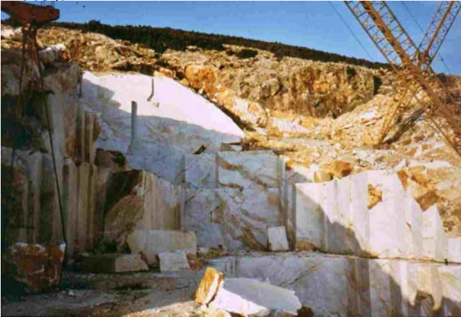
Abbildung 199: Moderner Marmorabbau zwischen Aphrodisias und den antiken Brüchen. Erkennbar ist die Begrenzung des gewinnbaren Volumens durch Dolomiteinschaltungen
