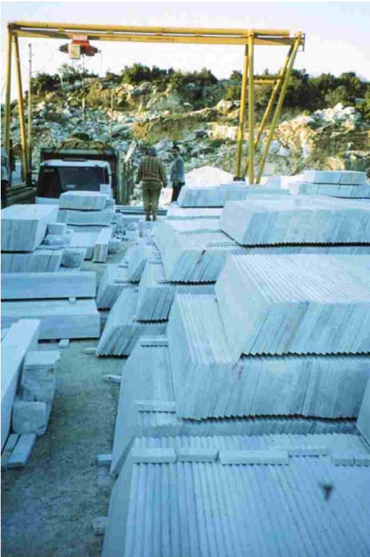
Abbildung 91: Gesägte Platten in lokalem Marmorbetrieb (Dincer-Werk) auf Marmara
