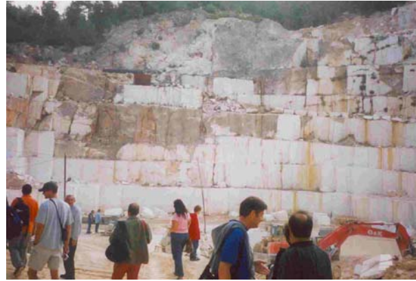
Abbildung 117: Moderner Dolomitmarmorsteinbruch (Cape-Vathy-Typ) südlich von Limenas in N-Thasos
