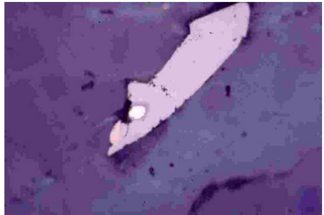
Abbildung 69: Auflichtaufnahme von prokonnesischem Marmor mit größtenteils in Magnetit (0,8 mm lang) umgewandeltem Eisensulfidkorn
