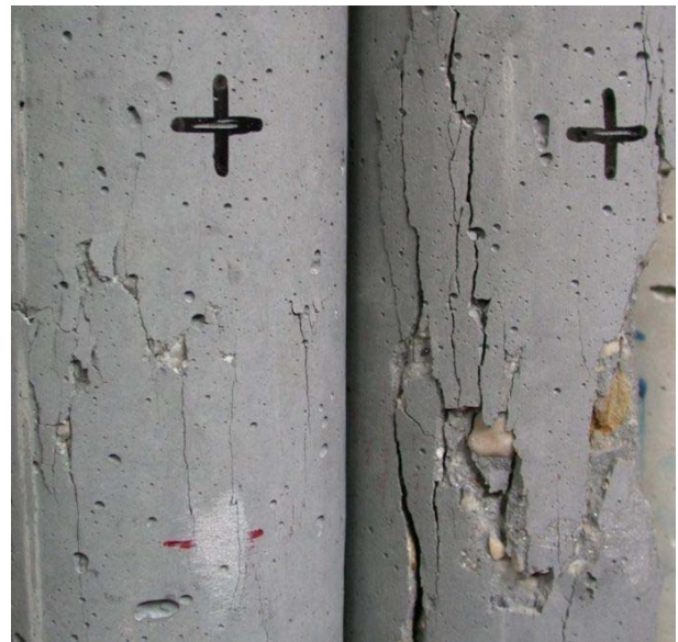
Abbildung 66: Rissbild bei hoher Beanspruchung ( \sigma_0 \geq 0,75 \beta_c )
