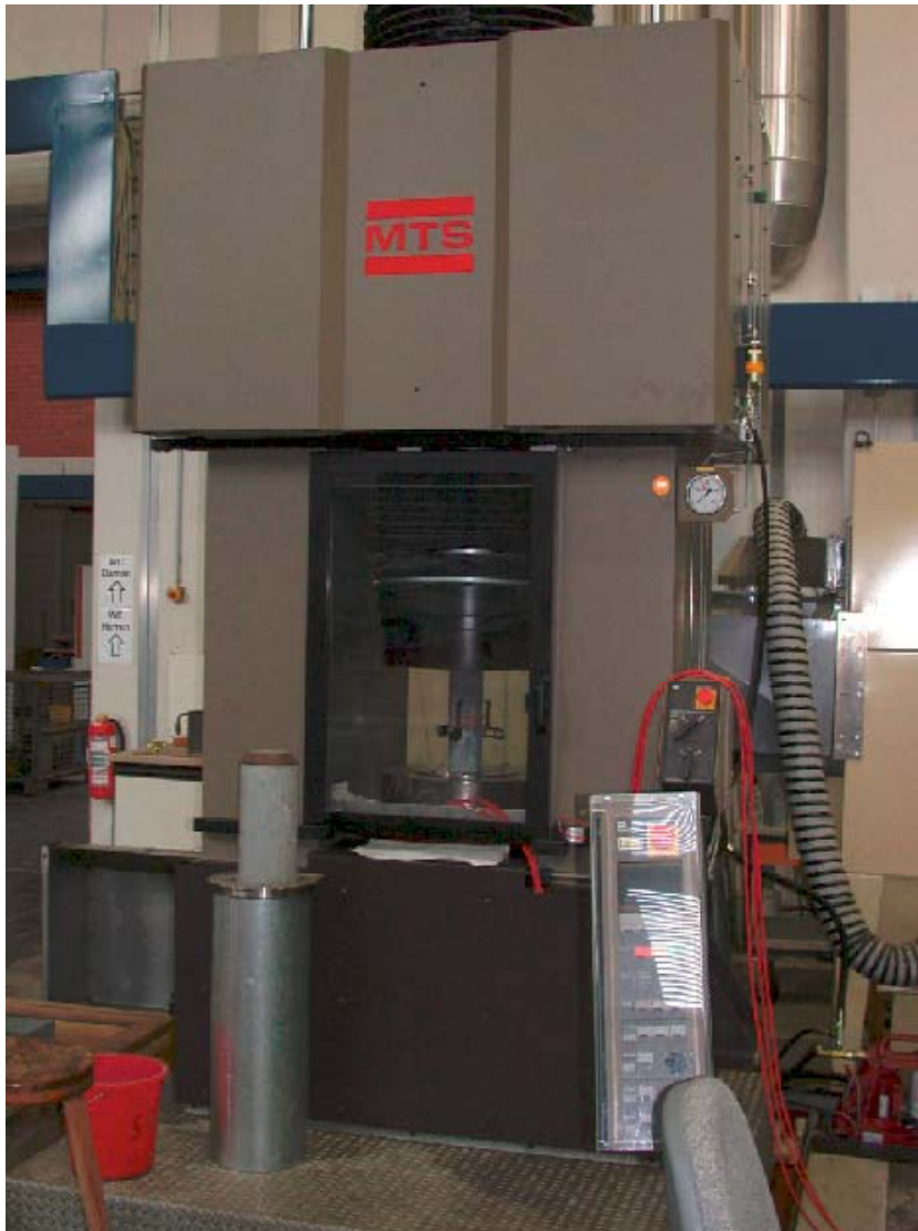
Bild 4: Prüfmaschine MTS 5 MN
