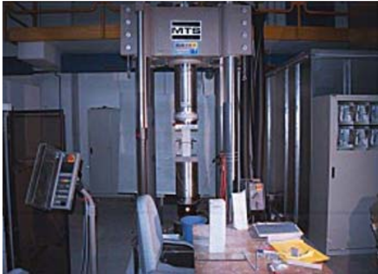
Bild 2: Prüfmaschine MTS 1 MN
