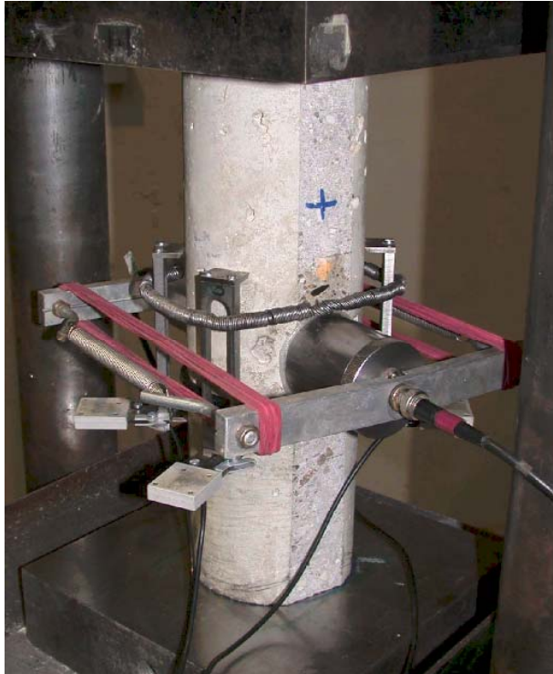
Bild 5: Statischer Bruchversuchsaufbau mit Ultraschall-Laufzeitmessung
