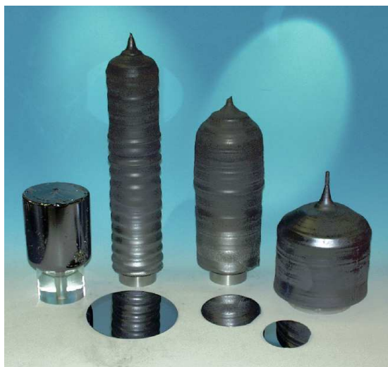
Abbildung 1.1: Oben: Einkristalline GaAs-Zylinderstäbe der Firma Freiberger Compound Materials bevor sie in einzelne Wafer zersägt werden. Unten: polierte Wafer.
