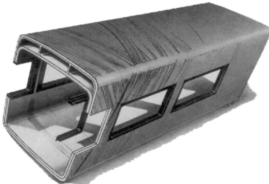
Bild 18 Wagenkastenrohling in FVK-Wickeltechnik [Schindler AG, AND95]
