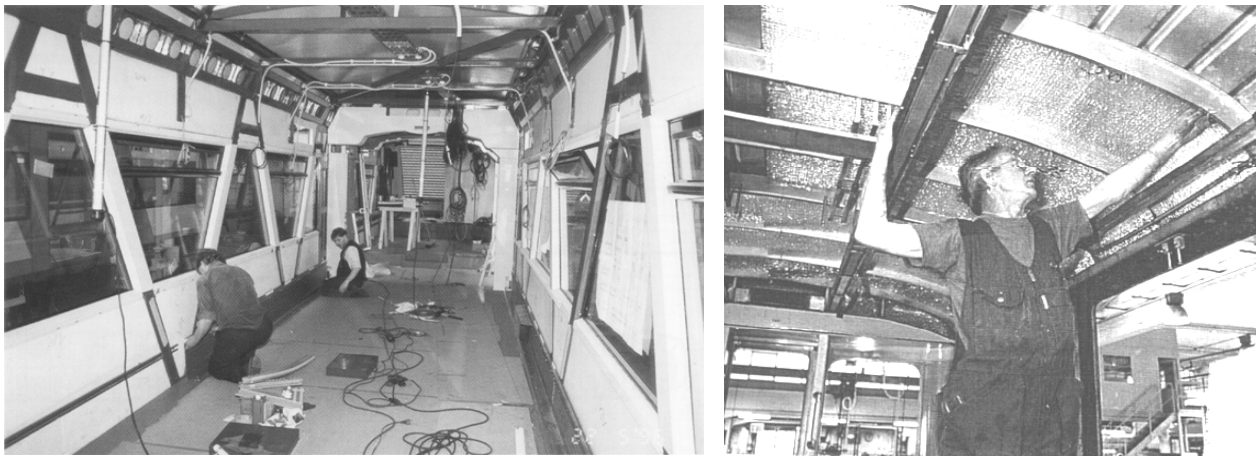
Bild 29 Unergonomischer und beengter Innenausbau eines Wagenkastens
