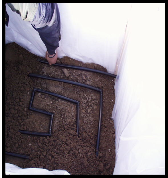
Foto 2 u. 3: Register zur Beeinflussung der Oberflächen- bzw. Unterbodentemperatur
