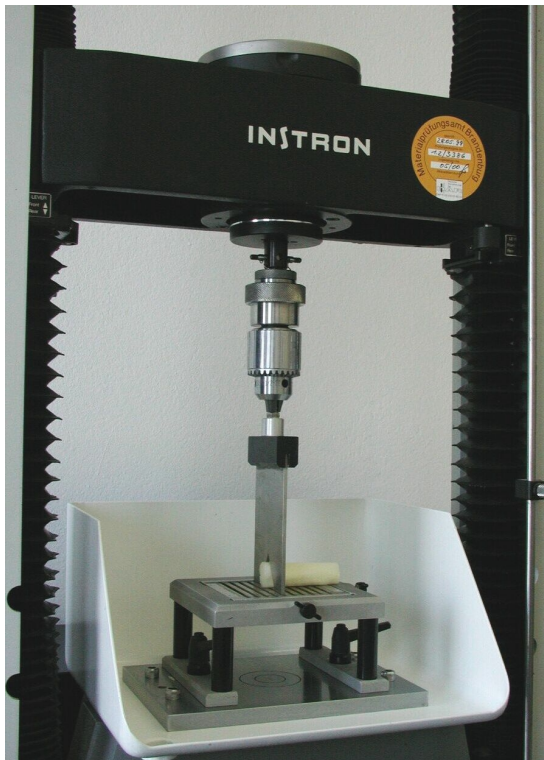
Foto 5: Instron-Universalprüfmaschine mit Scherblatt nach Warner-Bratzler
