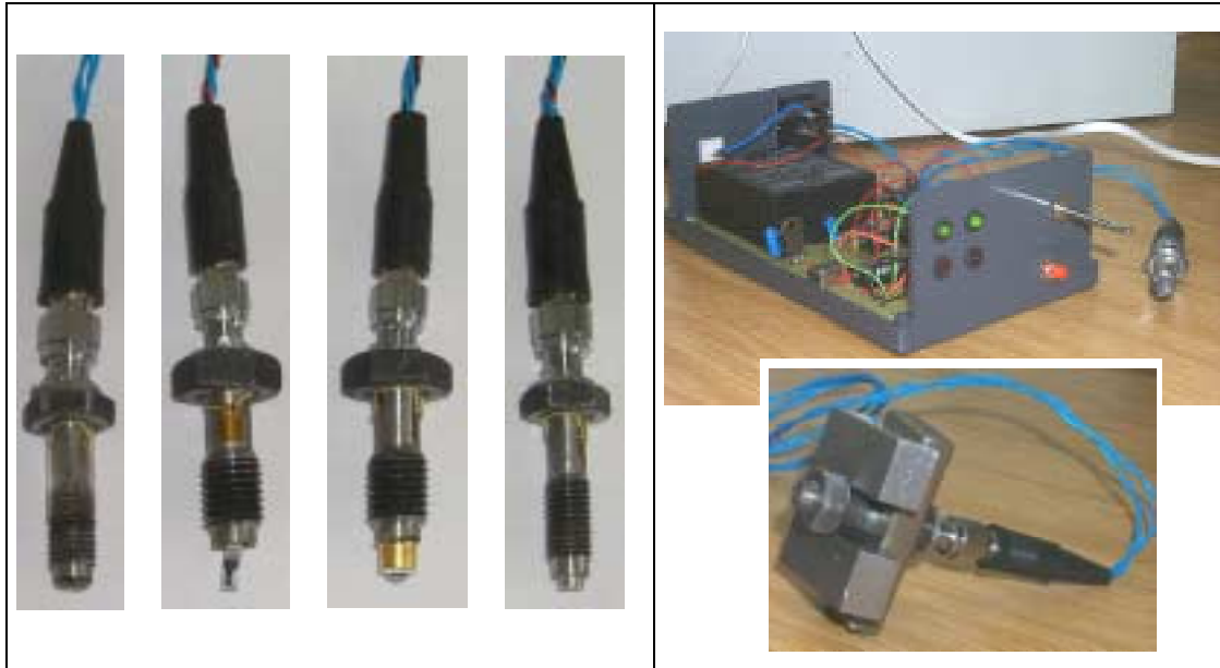
Bild 74: links: prototypische Schrauben mit integrierten Sensoren zur Überwachung der Vorspannkraft über DMS und je einer Umweltgröße (Temperatur, Luftfeuchtigkeit, UV-Strahlung und Helligkeit) rechts: Schraube mit integrierten Sensoren für Vorspannkraft und Temperatur mit LCB und LED-Anzeige sowie Klemmvorrichtung
