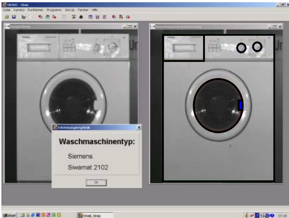
Bild 39: Informationen zum erkannten Waschmaschinentyp, links: Originalbild Waschmaschine; rechts: Originalbild mit erkannten Merkmalen [SEL-00a]
