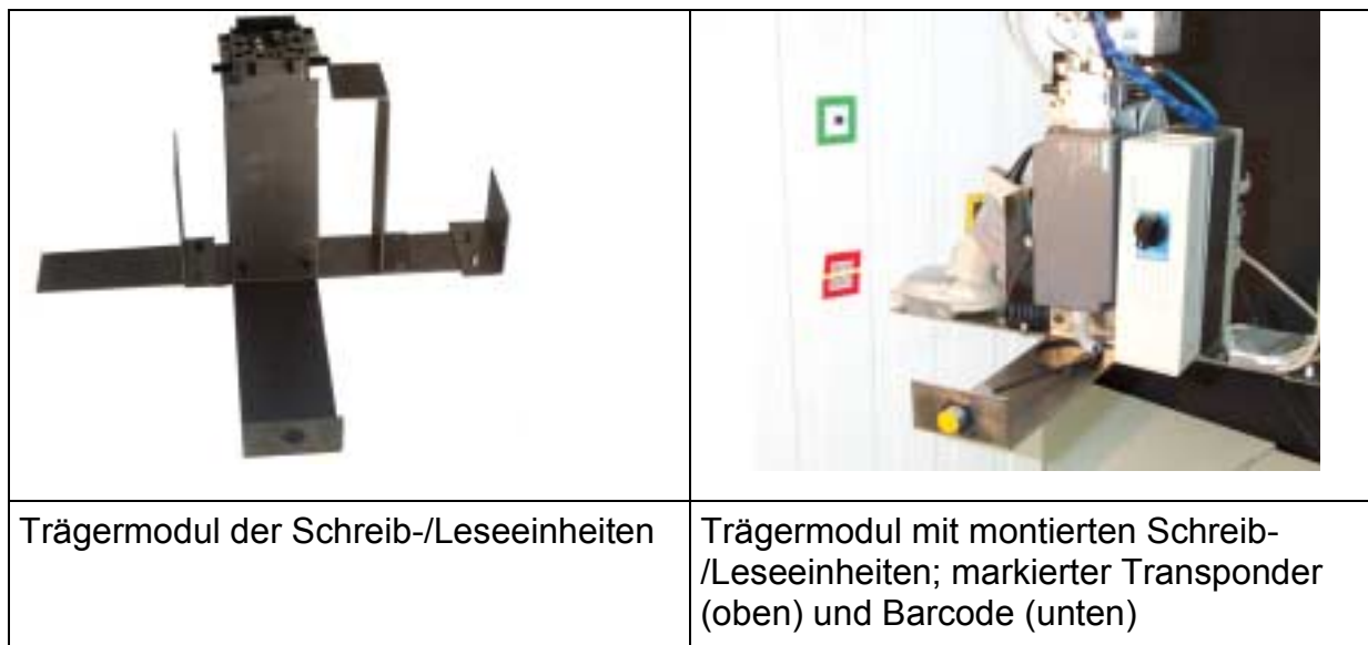
Bild 56: Komponenten des Lese- und Schreibsystems für Barcodes und Transponder (Fortsetzung in Bild 57)
