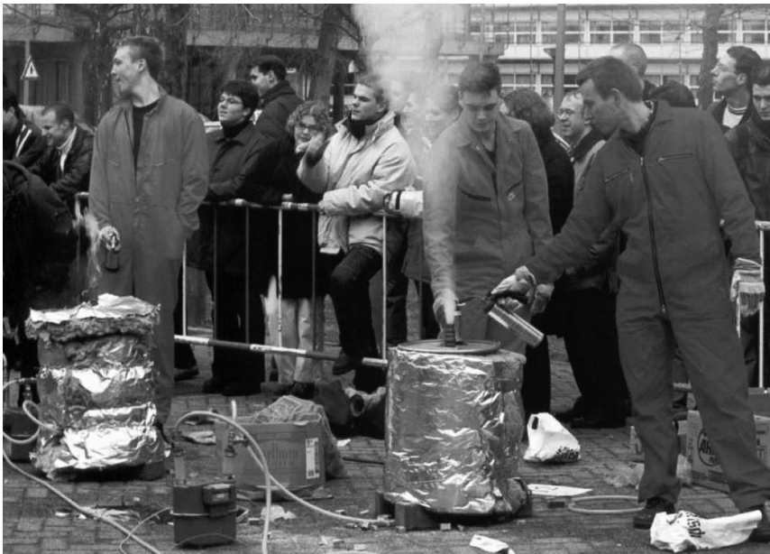
Een voorbeeld van duurzaamheid in werktuigbouwkunde onderwijs is de biomassaver-gassingscase. Studenten worden vertrouwd gemaakt met biomassa als duurzame energiebron en vergassing als kansrijke technologie. Op basis van een olievat wordt een constructie bedacht en in de werkplaats in elkaar gezet (linksboven). Vervolgens wordt de constructie getest. Eerst wordt hiertoe een houtvuur in het vat gemaakt (rechtsboven). Dan wordt het vat afgesloten en de zuurstoftoevoer met perslucht gereguleerd. Dit levert een brandbaar gas op dat afgetakeld wordt (onder, links) of een flinke rookpluim geeft (onder, rechts). (Foto: WOC/W/TUE)
