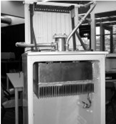
Een groep studenten werkt in het kader van een internationaal multidisciplinair project aan het ontwerp, bouwen en testen van een prototype van een Stirlingmotor gekoelde koelkast op zonnecellen. Foto: T.ADRIAANS
