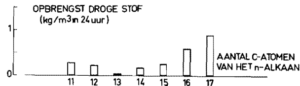
Fig. 41 Entmateriaal voorgekweekt op een mengsel van n-hendecaan tot en met n-hexadecaan.
