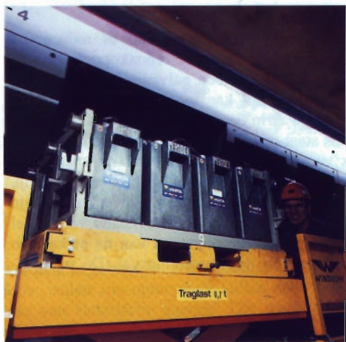
4, 5 en 6. In de Duitse hoge-snelheidstrein ICE is een grote hoeveelheid galvanische cellen verwerkt. Grote accu's moeten de stroomvoorziening garanderen als de trein bij stilstand niet meer met de bovenleiding is verbonden. Kleine batterijen zorgen ervoor dat de informatie die is opgeslagen in de boordcomputers niet verloren gaat.
