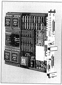
De hier afgebeelde Analog Signal Recorder kan 2 signalen bemonsteren met een frequentie van 20 MHz. Desgewenst kan door hdeze module zelf een middeling worden uitgevoerd over een aantal opeenvolgende perioden van elk signaal. Indien nodig kan ononderbroken in de tijd worden gemeten
