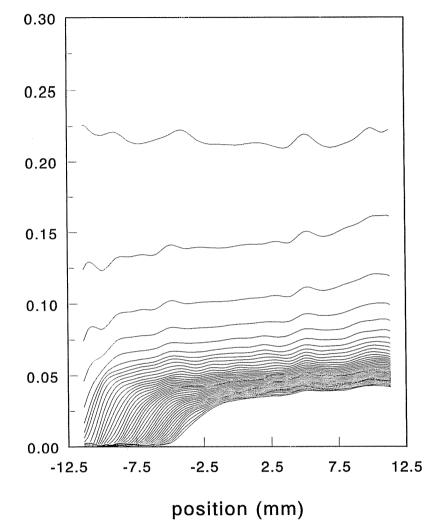
Het drooggedrag van rode baksteen. Bij dit experiment werd een met vocht verzadigd proefstuk gedroogd door er aan één kant lucht langs te blazen (linkerzijde in de figuur). De met behulp van MRI gemeten vochtprofielen corresponderen met tijden die onderling steeds een uur verschillen. Na ongeveer 7 uur blijkt een droogfront te ontstaan, dat langzaam de steen intrekt.
