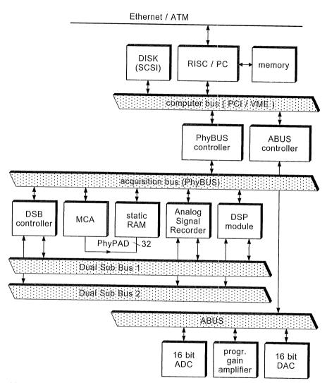
Voorbeeld van een modulair opgezet data-acquisitie systeem. Door het gebruik van meedere bussystemen wordt een grote flexibiliteit bereikt en worden communicatie-bottlenecks weggenomen.
