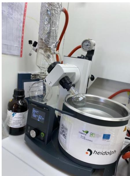
Figura 12 - Evaporação da fração etanólica em evaporador rotativo para determinação de açúcares.
