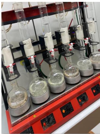
Figura 11 - Extração de gordura em aparelho Soxhlet.
