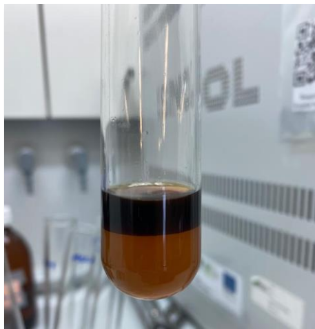
Figura 17 - Separação de fases na análise de ácidos gordos.
