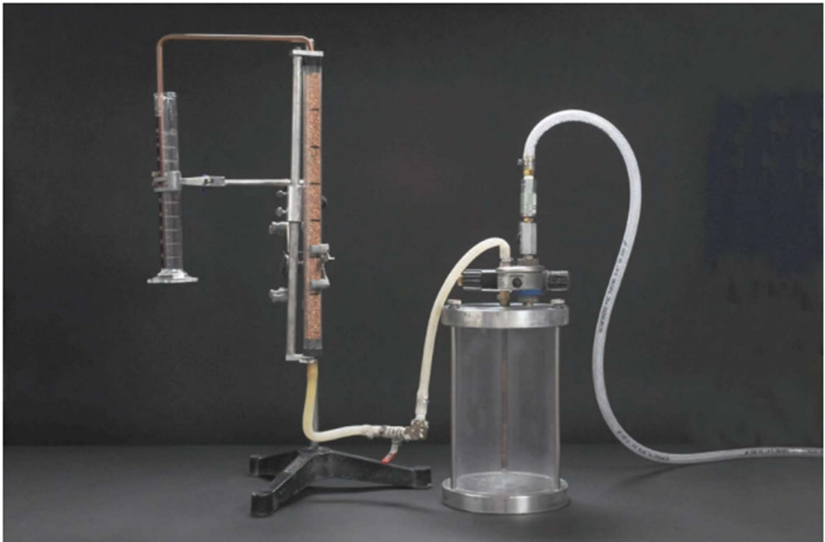
Figura 31 - Sistema montado para a realização do teste de injeção (Beril et al., 2013)
