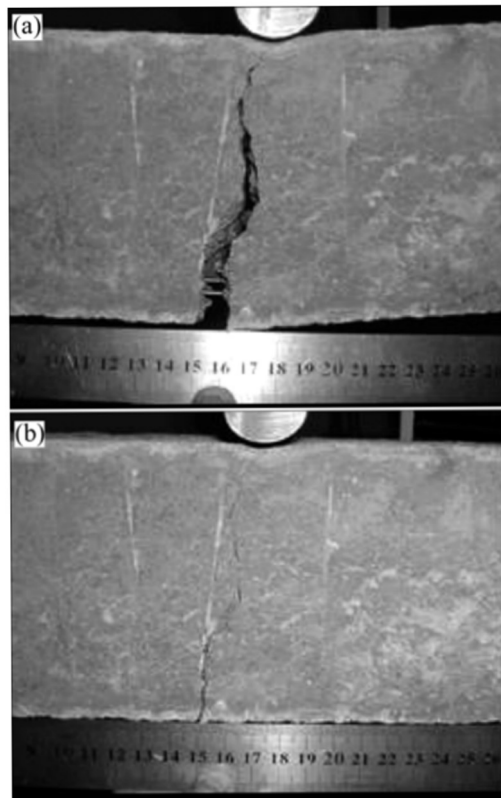
Figura 21 – a) Deflexão máxima. b) Após descarregamento a fissura diminui, aproximando do aspecto antes do carregamento (Adaptado de Kuang e Ou, 2008)
