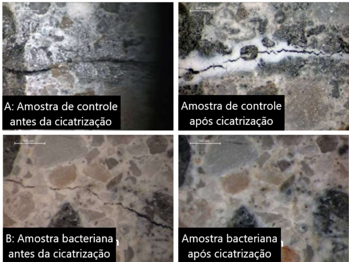
Figura 27 - Imagem microscópica da amostra de controle (A) e da amostra com agentes bacterianos (B). Na direita antes do processo de auto cicatrização e na esquerda após duas semanas submersa em água, com processo de auto cicatrização realizado (Adaptado de Jonkers)
