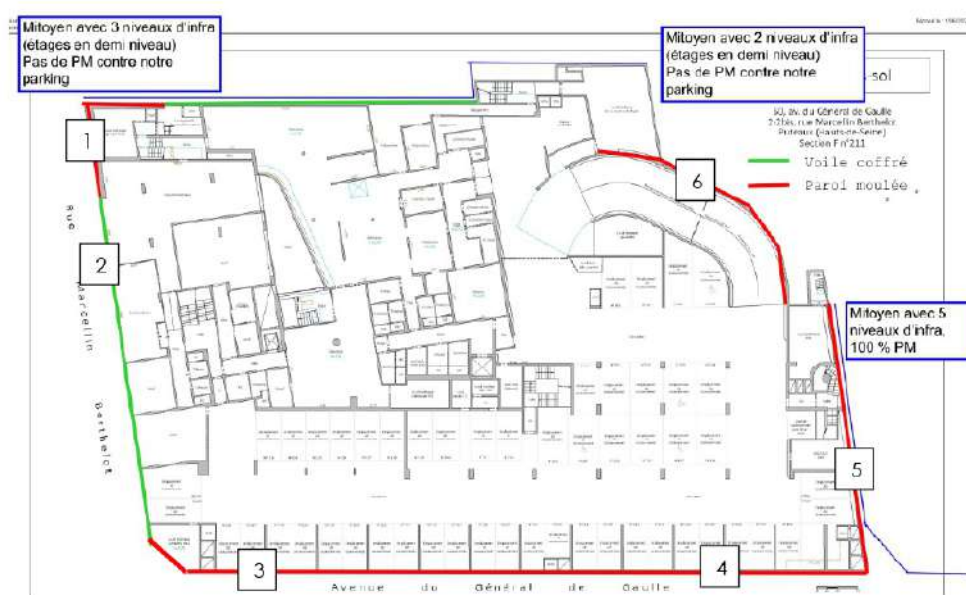
Figura 3: Paredes periféricas existentes
