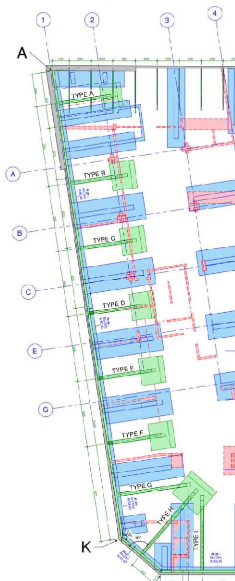
Figura 17: Posicionamento das escoras (lado oeste)
