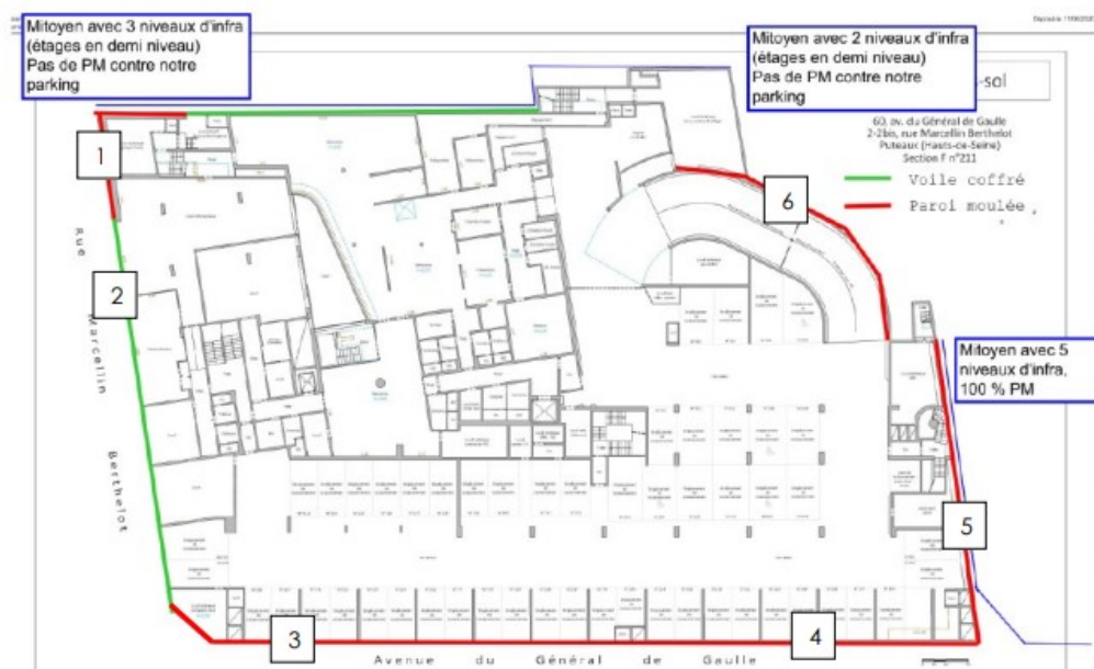
Figura 9: Tipos de paredes periféricas existentes no subsolo
