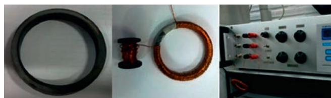
Fig. 4. Peça sinterizada, bobinamento secundário e traçador de curva de histerese
