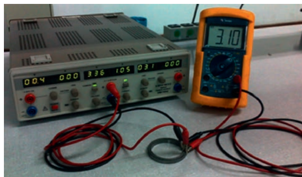
Fig. 5. Aparato para realização do ensaio de resistividade.
