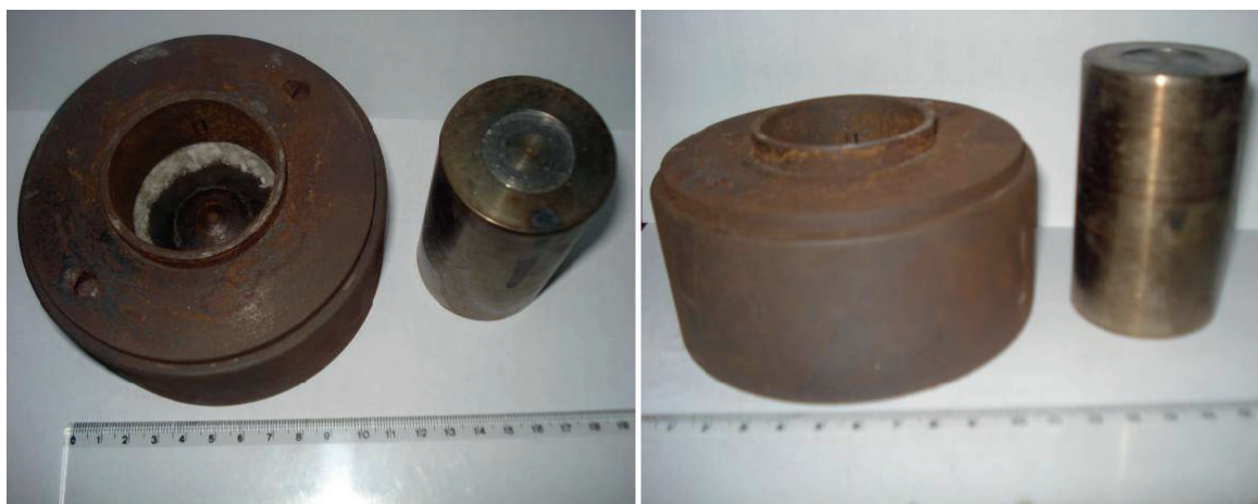
Fig 8. Dispositivo em aço ferramenta AISI H13 para conformação de alumínio.
