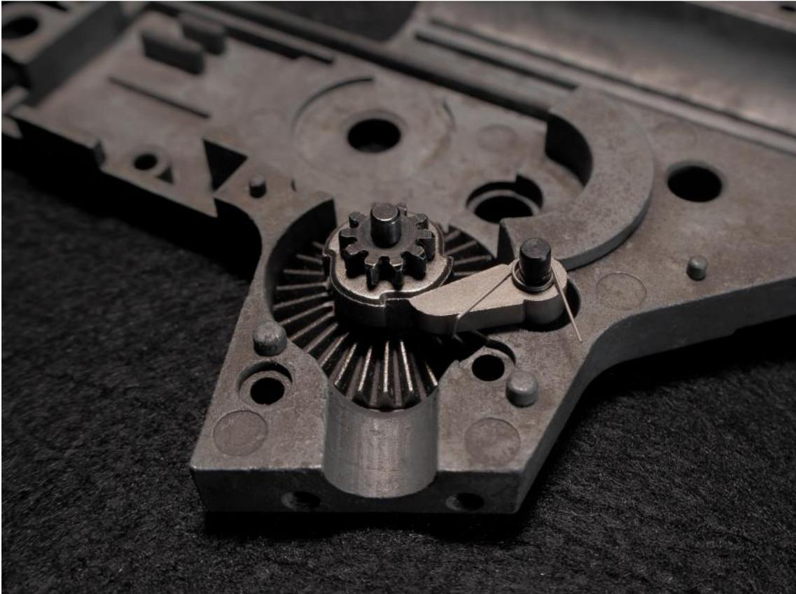
*Fig. 12: Pestaña anti retorno. Un muelle torsional hace presión contra unos dientes que permiten el deslizamiento de esta palanca por encima de ellos solo en sentido anti horario. [10]*
