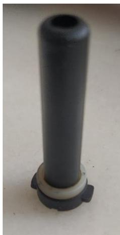
*Fig. 21: Guía de muelle. Obsérvese el tope de polímero blanco que actúa como cojinete rudimentario para favorecer el movimiento rotatorio del muelle alrededor de su eje longitudinal.*
