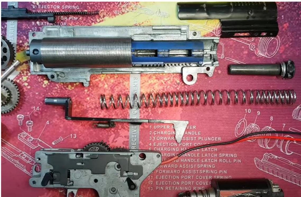
Fig. 19: Gearbox divisible de ICS. Nótese como el armazón tiene una pieza para el sistema neumático y el muelle y otra para el resto de la gearbox. [19]
