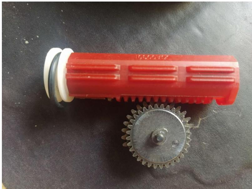
*Fig. 50: Engrande de sector gear con el pistón. Aquí se observa claramente que la semicorona debe ser más grande que la corona completa para evitar el contacto.*
