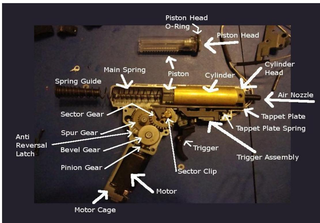
Fig. 15: Gearbox abierta y parcialmente desmontada. [15]
