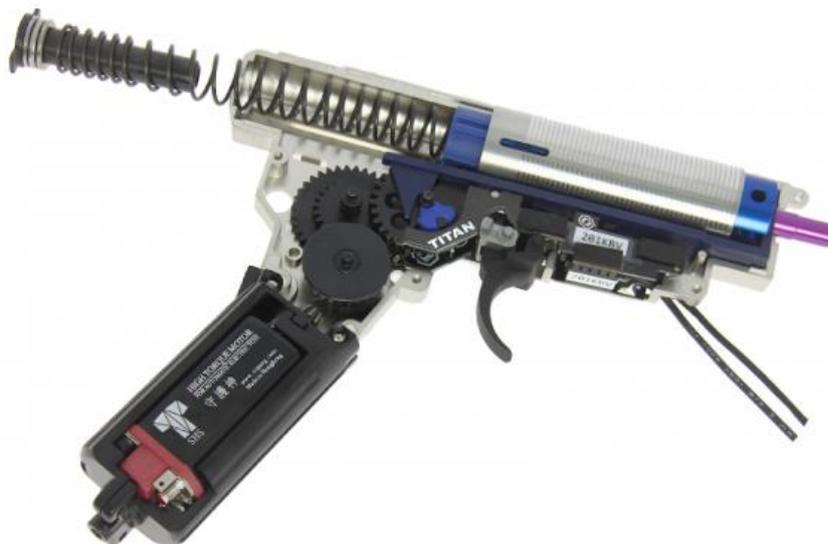
*Fig. 18: Gearbox V3. Nótese que el motor va en un compartimiento independiente. [16]*
