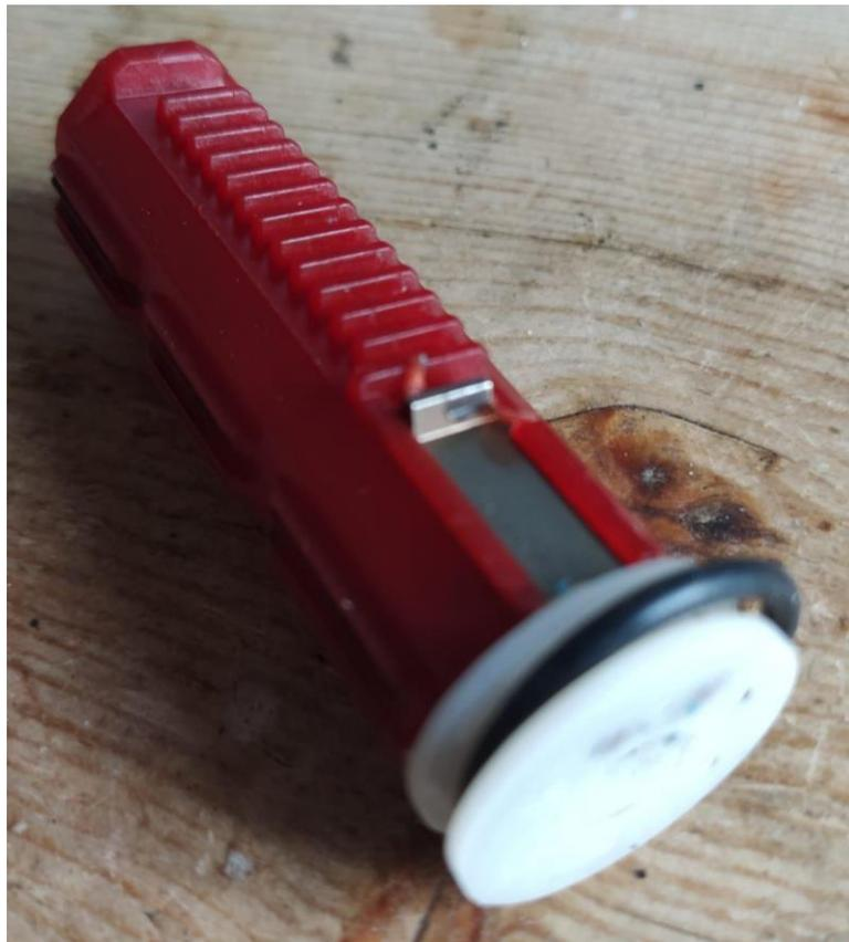
*Fig. 7: Vista frontal / inferior del pistón.*
