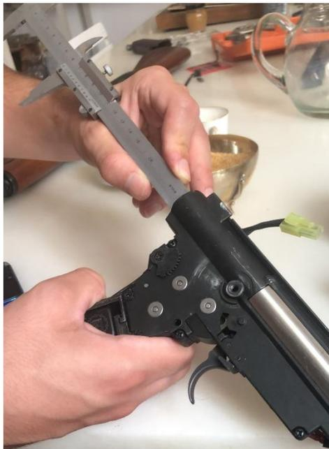
*Fig. 25: Medición del espacio entre la cabeza del pistón y la parte posterior de la gearbox.*
