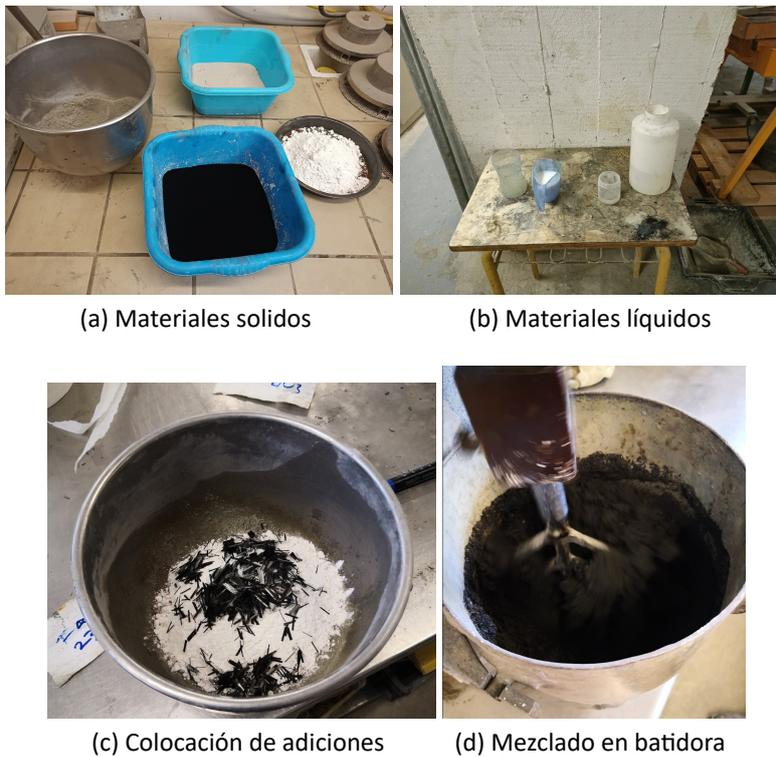
Figura B.1.1: Materiales para mezcla en laboratorio
