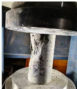
(c) Ensayo de compresión en cilindro
