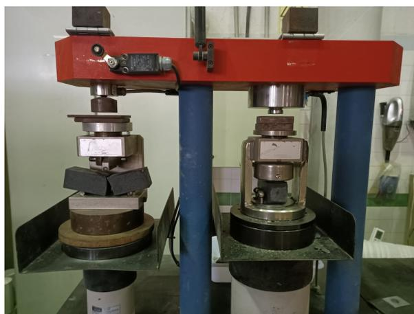
Figura 5.3.1: Fotografía de los ensayos de flexión y compresión.
