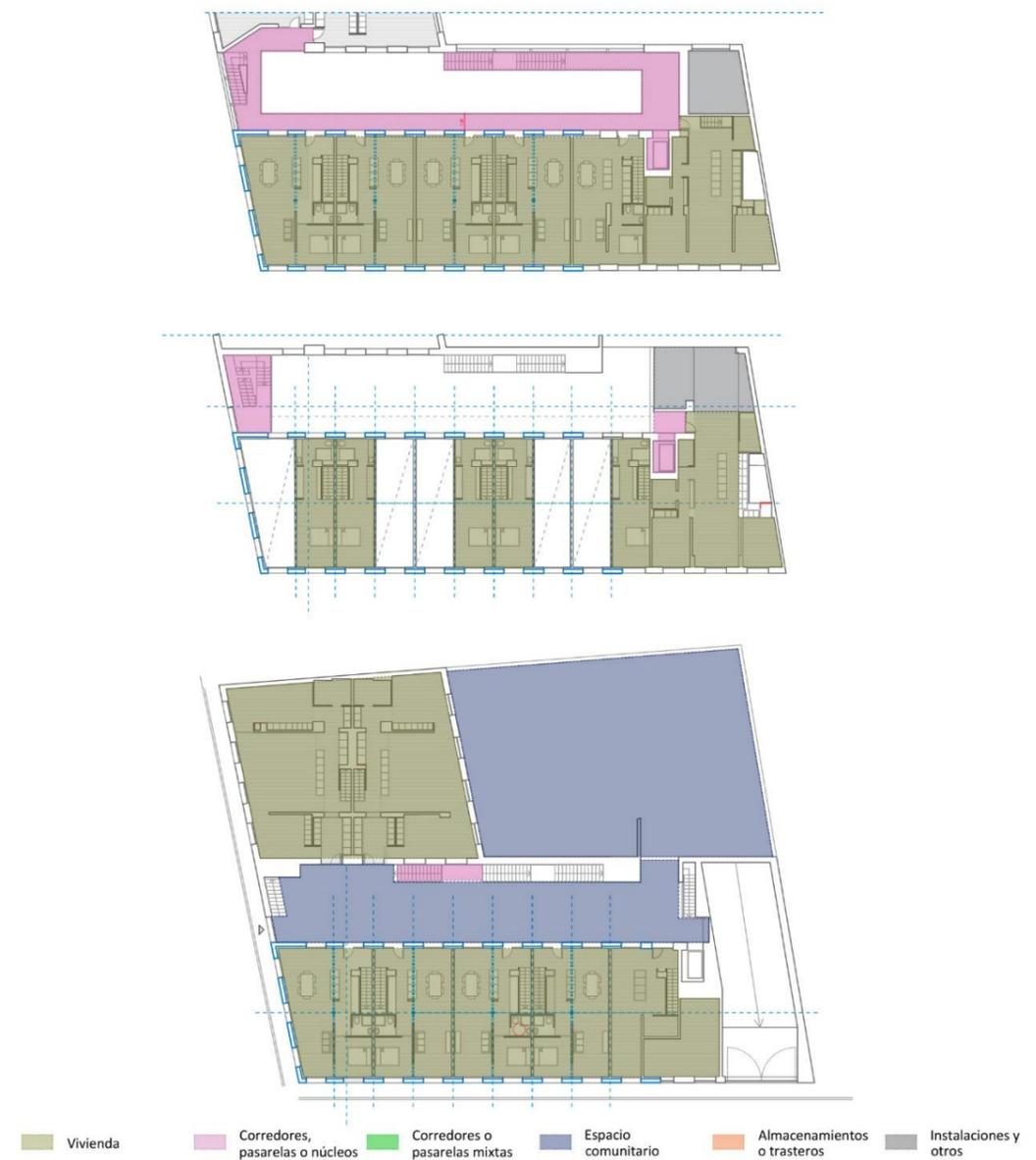
Figura 55. ESQUEMA. Distribución de los usos de la intervención fábrica Tort Can Planell.
