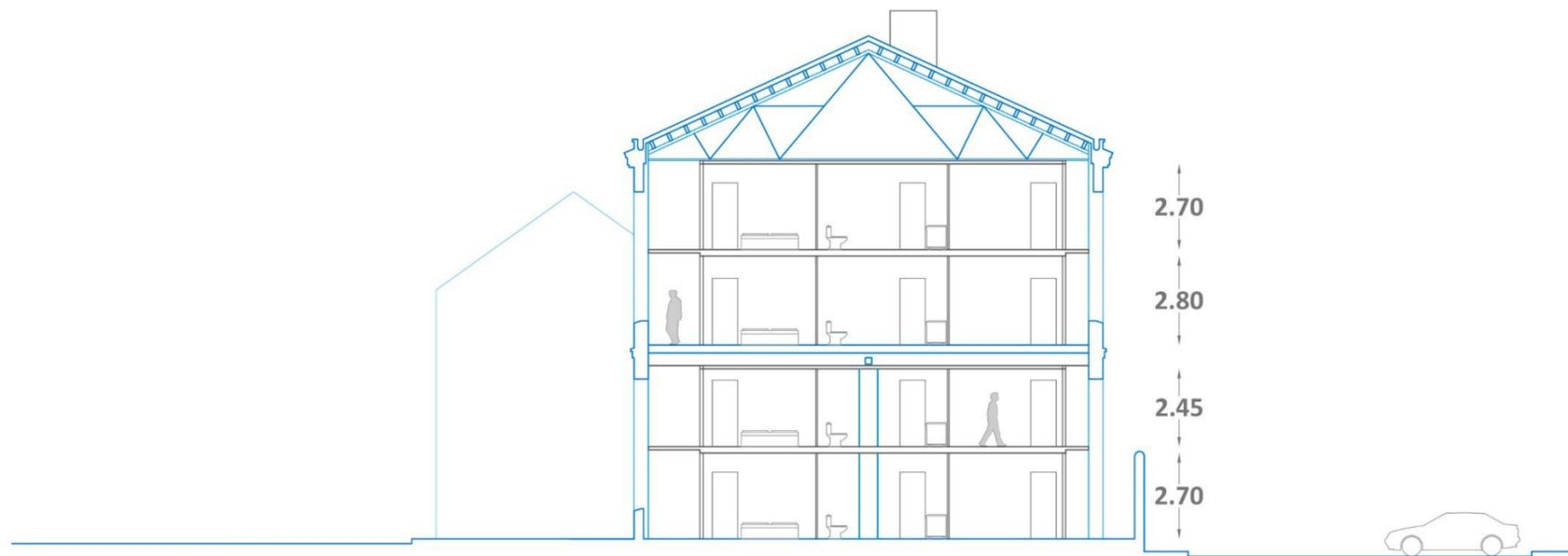
Figura 35. PLANO 1/200. Sección intervención nave G fábrica Fabra i Coats.
