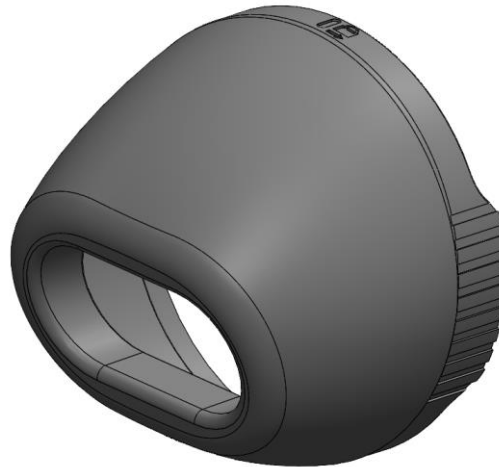
Figura 67. Embocadura del disseny final (font pròpia)
