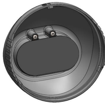
Figura 57. Fixació amb cargols REMFORM de 2,5mm de la vàlvula antiretorn a l'embocadura (font pròpia)
