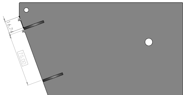
Figura 62. Unión mediante soldadura de la placa delantera soporte amoladora y las orejas soporte amoladora. Cotas en mm. Fuente: elaboración propia.
