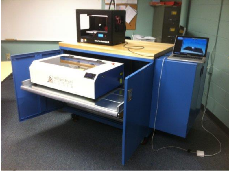
Fig. 2: Fab Lab mòbil amb l'equipament mínim: PC pel disseny, impressora 3D i tall làser (Mckay & Peppler, 2013)
