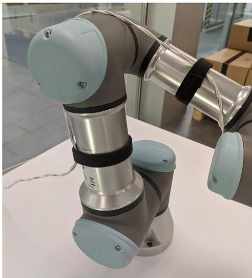
**Figura 3.31.** Sujeción del cable de alimentación al brazo del robot
