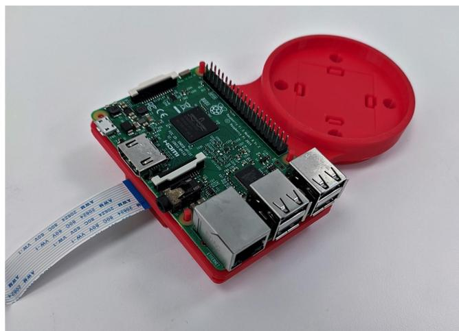
**Figura 3.22.** Cuarto paso del montaje: colocar la Raspberry Pi en la sujeción raspberry-robot
