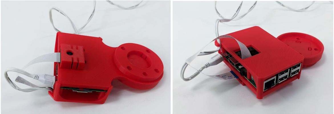
**Figura 3.27.** Sistema de visión ensamblado
