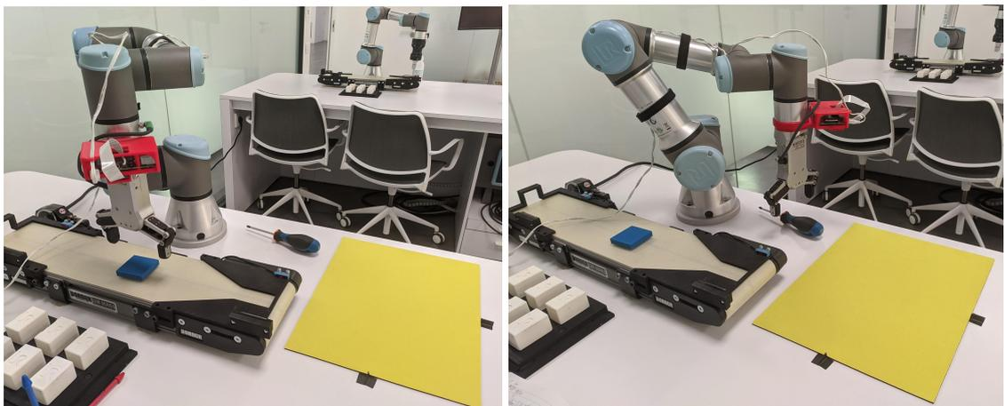
Figura 7.23. Posición “place” del cuadrado (izquierda) y del destornillador (derecha)
