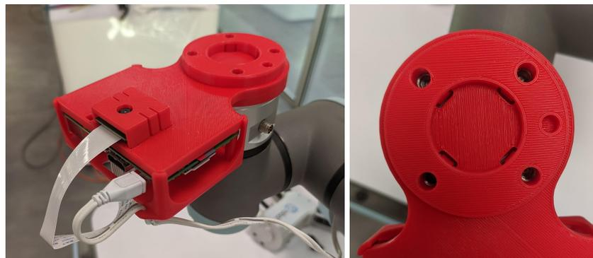
**Figura 3.28.** Primer paso de la instalación: encajar el sistema de visión a la muñeca del robot
