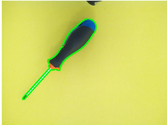
**Figura 4.19.** Contorno dibujado en verde sobre la imagen original
