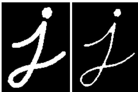
**Figura 4.13.** Operación morfológica de erosión: imagen original (izquierda) e imagen erosionada (derecha) [10]
