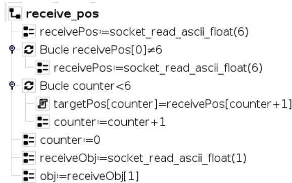
Figura 6.3. Sección del programa de robot para recibir posición y tipo de objeto de la Raspberry
