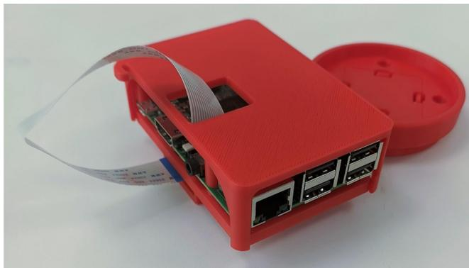
**Figura 3.25.** Séptimo paso del montaje: encajar la tapa de protección
